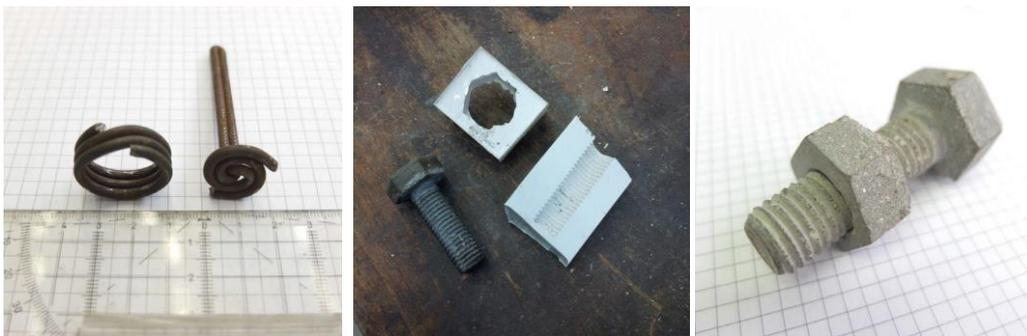
Abbildung 1: Die Betonschrauben für das Kanu: Bewehrung (links), Schalungsteile (Mitte) und fertige Schraube mit Mutter (rechts)
